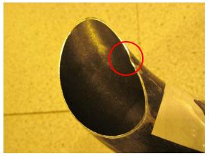
Поврежденным признается глушитель, имеющий значительные повреждения: глубокие вмятины (глубина более 2 мм), дырки, царапины на хромированных деталях и деформацию глушителя
